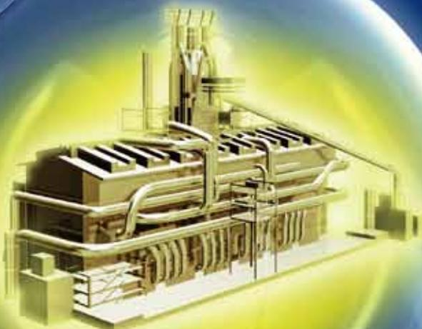
鉄をつくる電力は、自らまかないと。新日鉄は効率的なエネルギー利用を極限まで追求し、世界トップレベルの省エネルギー技術を実現してきました。製鉄プロセスで発生する副生ガスは100%回収して加熱炉などの燃料や発電に活かすとともに、排熱を蒸気や電力として回収・利用。製鉄所の総使用電力の約89%を自家発電しています。震災後の電力不足のなかで、全社が可能な限り省電力を推進し、さらには電力会社との共同火力発電所の運営や電気供給事業を通じて、社会に貢献できるよう努力していきます。
