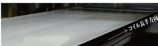
図6 SUS403焼入れ鋼帯の形状におよぼす冷却条件の影響 Fig. 6 Effect of cooling conditions on shape of quenched SUS 403.
