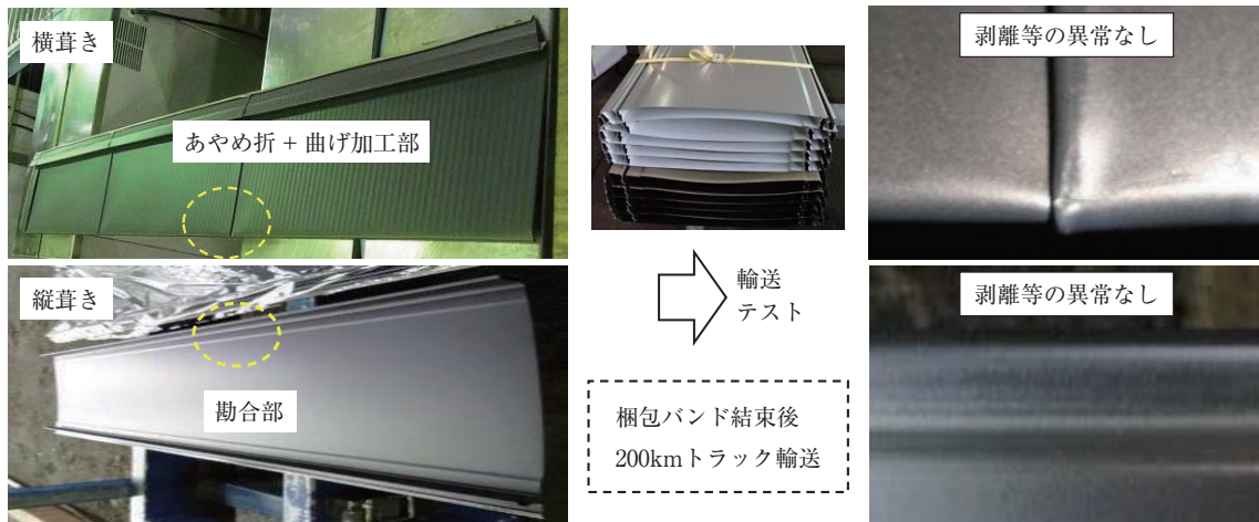
図6 月星スワンカラー成型加工品の輸送テスト結果 Fig. 6 Result of Transportation Test of MOONSTAR SWAN COLOR.
