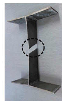
図14 複合サイクル腐食試験200サイクル後の試験片による引張試験後の外観の一例 Fig.14 Appearance of tensile test specimen after 200 cycles of combined cyclic corrosion test.
