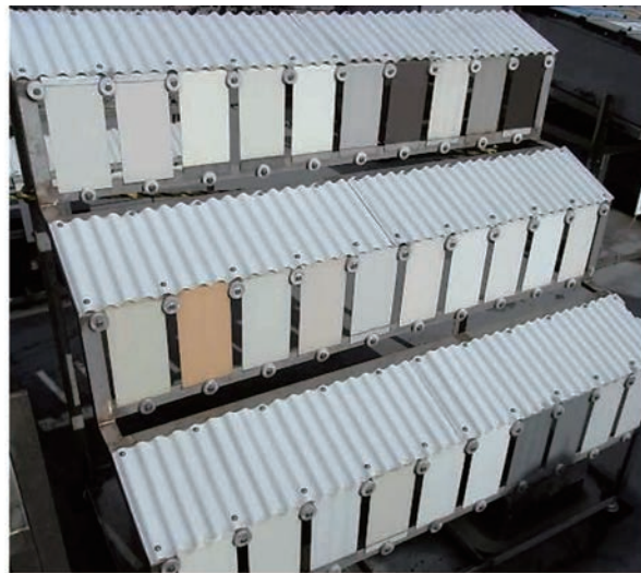
a) 雨筋汚れ暴露試験状況
