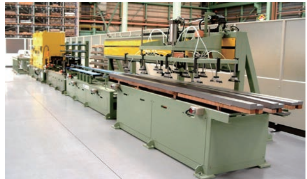
図4 レーザ溶接H形鋼の製造設備
