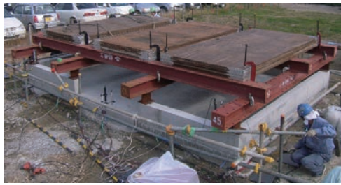
図6 モデル基礎スラブによる実験風景 Fig.6 View of the lift up experiment using a model base plate.
