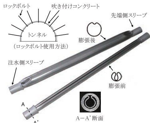
図3 トンネル掘削用の鋼管膨張型ロックボルト
