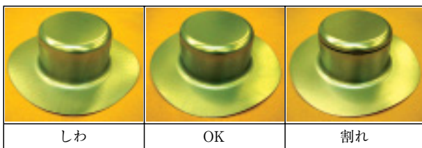
図4 円筒絞り加工品形状およびフランジしわと割れ発生状態
