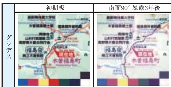
暴露場所: 千葉県市川市高谷新町 日新製鋼株式会社技術研究所内 サンプルサイズ: 100mm×100mm ホワイトステンレス耐候グロス(SUS430 2D)
