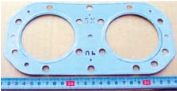
(a) ガスケット (板厚0.2mm)
