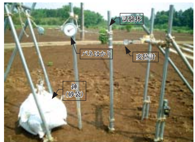
図11 水平加力試験状況 Fig.11 Horizontal pressing method.
