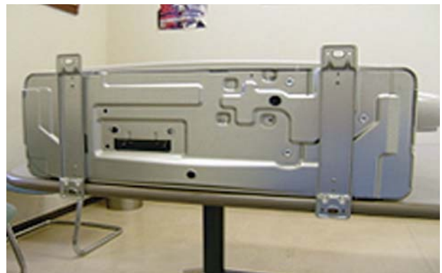
3) ZG処理（エアコン底板）
