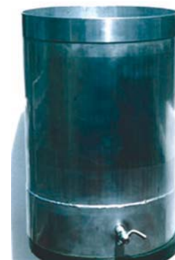
図15 ステンレス鋼製小型タンクの外観（材質：SUS304、サイズ：300mmφ×1000mm×1.2mmt）
