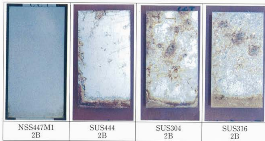
図5 塩乾湿複合サイクル試験後の発錆状態(1000サイクル)
