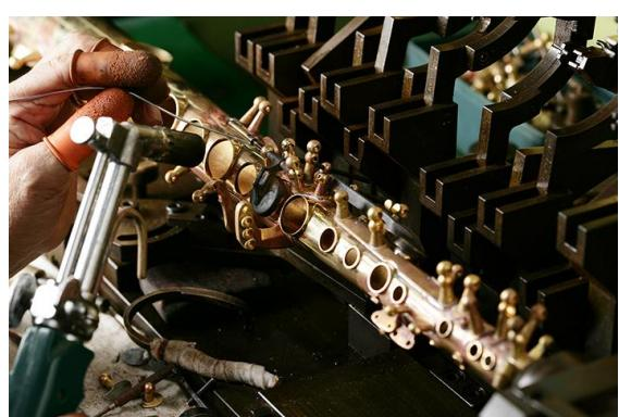
左： 製造工程 ボディの成形 右：製造工程 キーポストのロー付け
