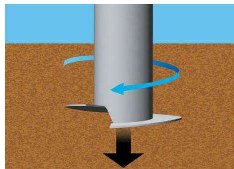
図1 回転による貫入施工
