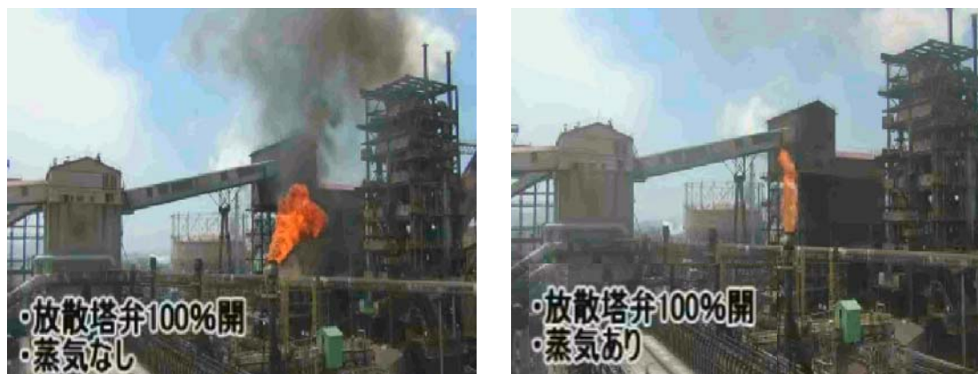
図 5.3 蒸気吹き込みによる黒煙抑制対策試験結果
