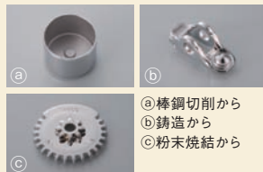
極軟質特殊鋼による板プレス化 ㊶ 棒鋼切削から ㊷ 鋳造から ㊸ 粉末焼結から
