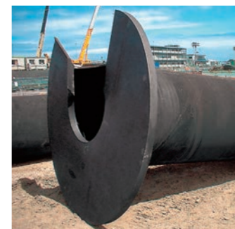
NSエコパイル® らせん状の羽根を先端に設けた鋼管を回転圧入する工法。羽根のくさび効果で地盤へのスムーズな貫入が可能。羽根の拡底効果により高い支持力を発揮します。
