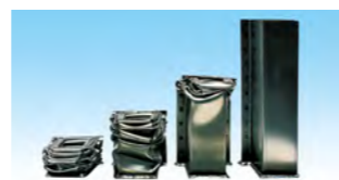
落下衝撃試験 (中の2体がハイテン)
