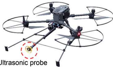
図3 超音波板厚計搭載ドローンの写真 Drone equipped with ultrasonic thickness gauge
