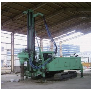
写真 3 小型杭打機® Small pile rotary machine®
