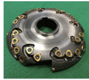
写真3 反転スカラップ用カッター Cutter for new shape weld hole
