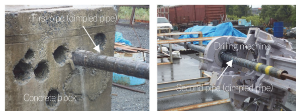
図10 ディンプル鋼管の模擬施工試験 Simulated construction test for dimpled pipe
