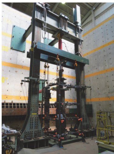
写真4 即結管べえ®の実大構造試験概況 Overview of full-scale structural test of “SOKKETSU KANBEE™”
